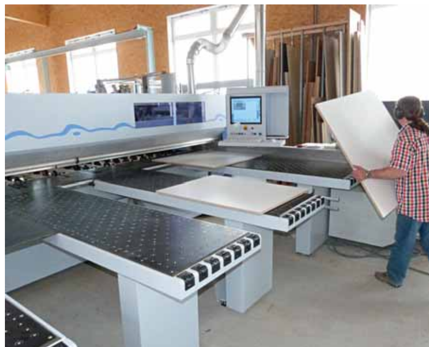
Nach dem ersten Aufteilen legt Bernd Ruttkowski die Platten für den weiteren Zuschnitt auf
