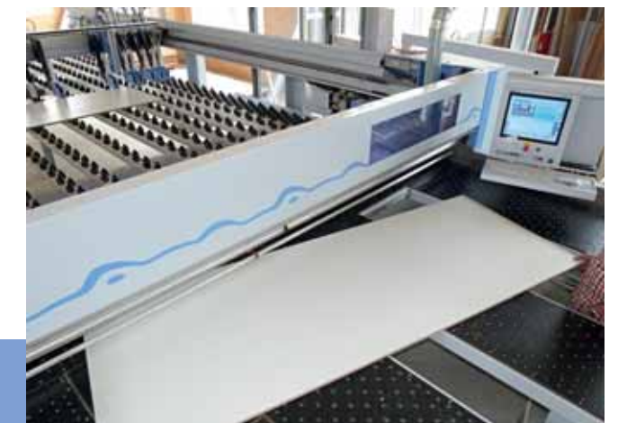
Die Druckluftdüsen der Arbeitstische erleichtern das Handling der Platten
